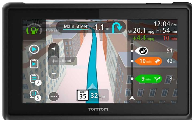
Ein TomTom PRO 82xx-Navigationsgerät verwendet OV2-Dateien für benutzerdefinierte *POIs*. Sie müssen die relevanten OV2-Dateien in den internen Speicher des Geräts kopieren.
